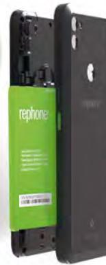
■ Wechselbarer Akku (4.500 mAh
