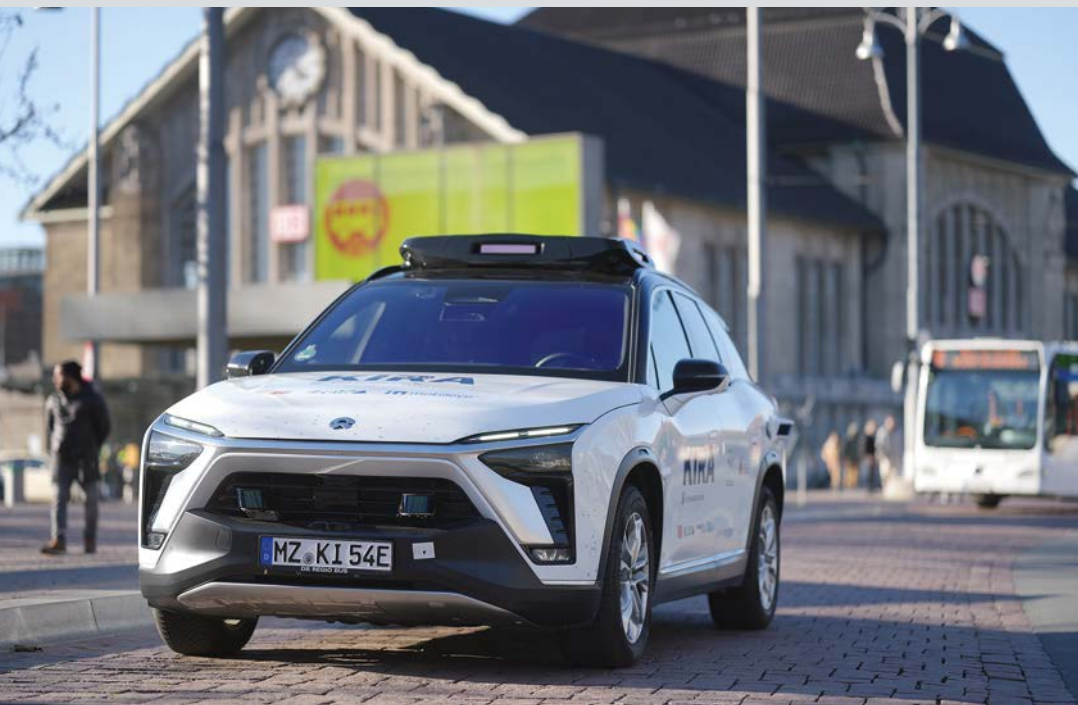
Fast schon autonom: Im Rahmen des Projekts KIRA im Rhein-Main-Gebiet werden hochautomatisierte Shuttles der Stufe 4 für den ÖPNV im Realbetrieb getestet. Hinter dem Lenkrad sitzt zunächst ein Fahrer oder eine Fahrerin, aber nur zum Eingreifen im Notfall.
